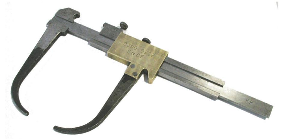
Pieds à coulisse à bec utilisé pour la mesure de la largeur du champignon ainsi que de la hauteur du rail. Le dixième de millimètre est apprécié. Un appareil à ultrason, le « Sofranel » permet également la mesure de la hauteur du rail. La fiabilité de la mesure dépendant plus de l'étalonnage du matériel.
